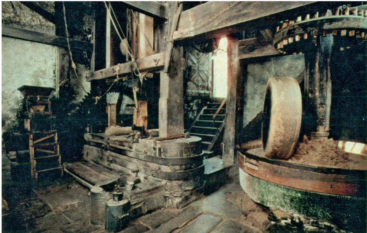
*In der Mitte steht die Ölpresse mit dem Schlegel, der die Keile in die Presse treibt. Im Kollergang (rechts) wird vor allem grosses Gut (Nüsse) gemahlen und gequetscht. Alles wird mit Wasserkraft angetrieben.*
